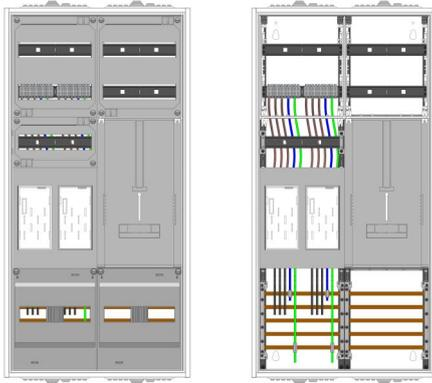
AEZ22-210-009, eHZ-Zählerverteilung nach VDE 0603, DIN43870, AR-N 4101:2015 für den Innenbereich für Wandbefestigung AP/UP, Fabr. Alphatec, BxHxT [mm] = 550x1100x210, Schutzklasse II, IP41, RAL 9016, Bestehend aus: Gehäuse, Einzeltür mit Drehriegel, Flansche NF1 (oben) und NF2 (unten) und Berührungsschutzabdeckungen, aufgebaut wie folgt: 2x Zählerplatz, 1x TSG-Platte, geeignet für TSG-Hutschienenmontage: nein, komplett zusammengebaut und verdrahtet gemäß VNB.0001
