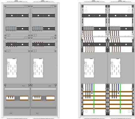
AEZ22-210-007, eHZ-Zählerverteilung nach VDE 0603, DIN43870, AR-N 4101:2015 für den Innenbereich für Wandbefestigung AP/UP, Fabr. Alphatec, BxHxT [mm] = 550x1100x210, Schutzklasse II, IP41, RAL 9016, Bestehend aus: Gehäuse, Einzeltür mit Drehriegel, Flansche NF1 (oben) und NF2 (unten) und Berührungsschutzabdeckungen, aufgebaut wie folgt: 2x Zählerplatz, komplett zusammengebaut und verdrahtet gemäß VNB.0001
