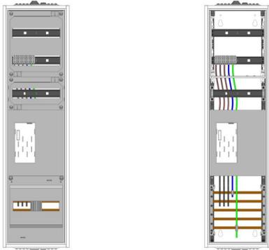
AEZ12-230-001, eHZ-Zählerverteilung nach VDE 0603, DIN43870, AR-N 4101:2015 für den Innenbereich für Wandbefestigung AP/UP, Fabr. Alphatec, BxHxT [mm] = 300x1100x230, Schutzklasse II, IP54, RAL 7035, Bestehend aus: Gehäuse, Einzeltür mit Schwenkhebel für Profilhalbzylinder, Flansche SF45 (oben) und SF41 (unten) und Berührungsschutzabdeckungen, aufgebaut wie folgt: 1x Zählerplatz, komplett zusammengebaut und verdrahtet gemäß VNB.0001
