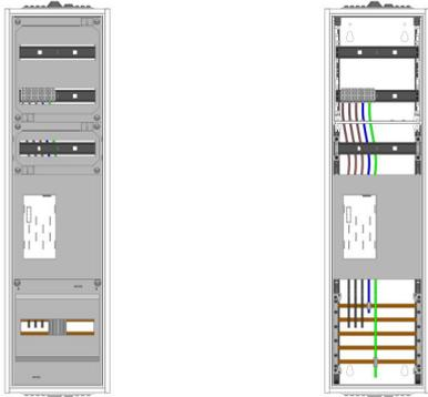
AEZ12-210-003, eHZ-Zählerverteilung nach VDE 0603, DIN43870, AR-N 4101:2015 für den Innenbereich für Wandbefestigung AP/UP, Fabr. Alphatec, BxHxT [mm] = 300x1100x210, Schutzklasse II, IP41, RAL 9016, Bestehend aus: Gehäuse, Einzeltür mit Drehriegel, Flansche NF1 (oben) und NF2 (unten) und Berührungsschutzabdeckungen, aufgebaut wie folgt: 1x Zählerplatz, 1x TSG-Platte, geeignet für TSG-Hutschienenmontage: ja, komplett zusammengebaut und verdrahtet gemäß VNB.0001
