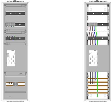
AEZ12-210-001, eHZ-Zählerverteilung nach VDE 0603, DIN43870, AR-N 4101:2015 für den Innenbereich für Wandbefestigung AP/UP, Fabr. Alphatec, BxHxT [mm] = 300x1100x210, Schutzklasse II, IP41, RAL 9016, Bestehend aus: Gehäuse, Einzeltür mit Drehriegel, Flansche NF1 (oben) und NF2 (unten) und Berührungsschutzabdeckungen, aufgebaut wie folgt: 1x Zählerplatz, komplett zusammengebaut und verdrahtet gemäß VNB.0001
