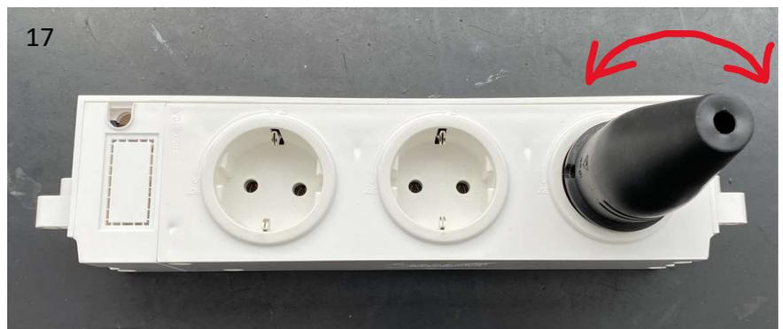
10. Weiter muss auch die Stromdurchgängigkeit geprüft werden. Dies ist von einer 2. Person durchzuführen. Dazu wird ein Messkabel in den Pol der ersten Steckdose eingesteckt und das zweite Messkabel in die zweite bzw. dritte Steckdose in den gleichen Pol (1 und 2). Nach gleichem Prinzip wird auch die Schutzableitung geprüft (3). Ist kein Durchgang vorhanden, muss das Steckdosengehäuse nochmal geöffnet und die Verdrahtung überprüft werden.
